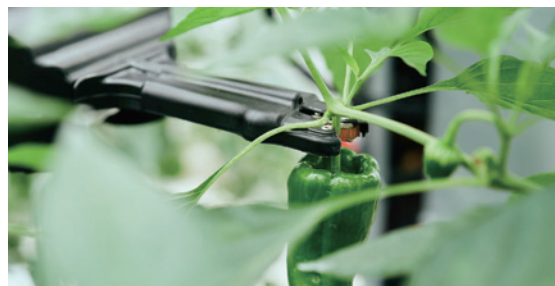
自動収穫ロボット『L』がピーマンを収穫する様子
