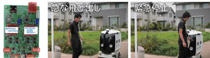
機能安全ユニットと自動搬送ロボット ハコボ®の緊急停止
