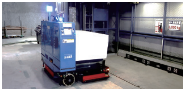
現場で資材搬送中のRobo-CARRIER
