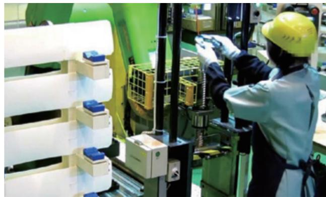
協働ロボットと作業員によるボールねじユニット組立の協働作業
