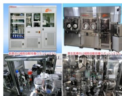
創薬向け細胞自動培養ロボットシステム
