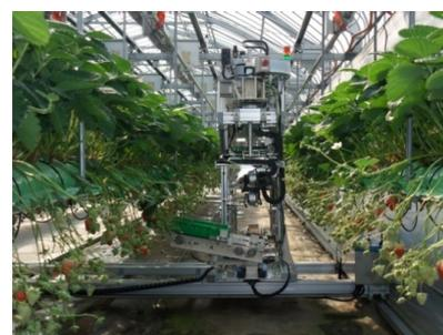
ハウス内栽培されたイチゴを3次元位置測定し、色味具合・熟度をカメラで判定し、果実を傷つけないよう果柄部分を切断しトレイに収容するロボット。夜間にロボットが収穫作業を行うことで、農家の作業負担を軽減できる。
