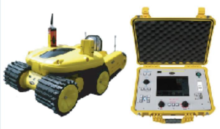
が起きているのか」その状況を今まで以上に、より早く正確に把握することがますます重要になっています。このような消防活動には生死にかかる危険が伴うため、ロボットなどの高度な資機材の投入が望まれます。「FRIGO-M」は、総務省消防庁消防研究センターの開発成果を基本に、三菱電機特機システム株式会社が共同研究により実用化に成功した「消防用偵察ロボット」シリーズです。災害現場で今まで以上に消防隊員の安全を確保し、的確な対処活動展開への活用が期待されます。
