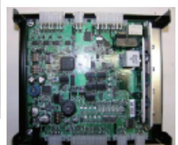
ジョイスティック式自動車運転装置の駆動装置
