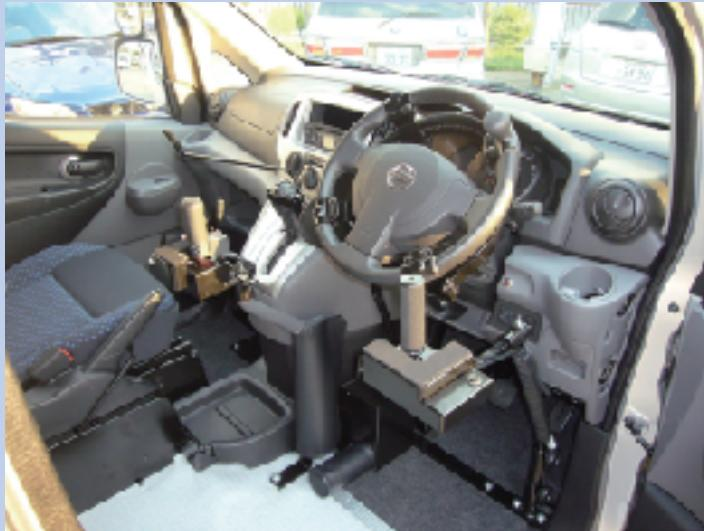
車いすを使用する重度の障害者を対象とした、自身による自動車運転を可能にする運転支援システム。ジョイスティックを操作することで、自動車のハンドル、およびアクセル・ブレーキペダルを電気モータで作動させ、自動車を運転する。車両後部には電動ハッチとリフトを備え、車いすのまま運転席に移動することができる。さらに車いすを運転席部分に固定する機構により、車いすのまま運転ができ移乗が不要である。
