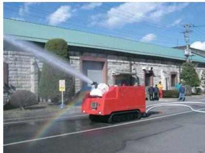
ンテナの採用により、マルチパスの影響を受けにくいクリアな映像を遅延時間80msec以下で伝送することが可能となりました。伝送画質は毎秒30フレームで640×480pixの高画質を確保しています。伝送距離は半径300m以上が可能です。
