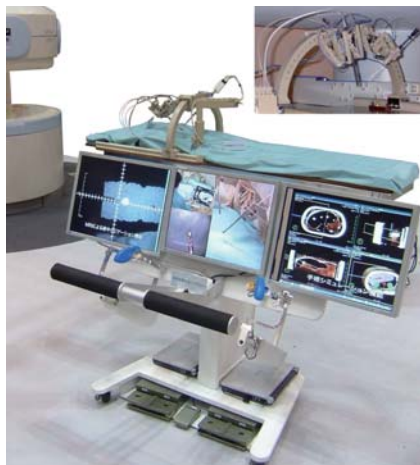
MR画像誘導下小型手術用ロボティックシステム (右上)MRIガンツリ内に設置されたMR対応小型手術用マニピュレータ
