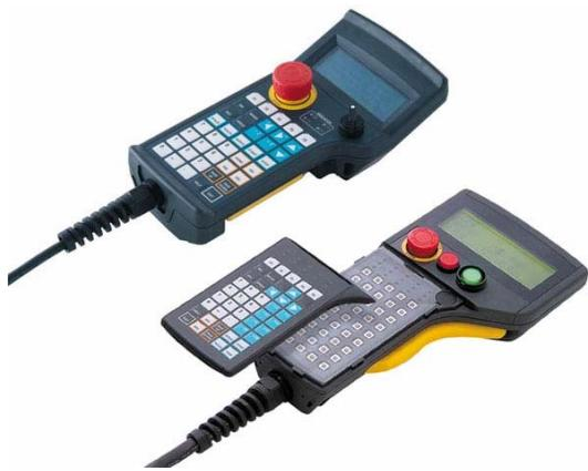
イネーブルスイッチと非常停止スイッチを搭載するなど、安全にも配慮している。産業用ロボットの縁の下の力持ち的存在で、これまでに累計 14,000 台を販売し、前年度比 190% を超えるスピードで伸長している。安全性および人と直接ふれるインターフェースの重要性に注力し、国際規格の策定にも積極的に取り組んでおり、国際市場での標準ペンダントとして期待が大きい。
