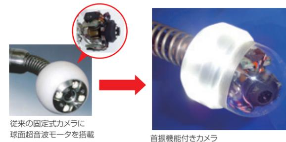
従来の固定式カメラに球面超音波モータを搭載
