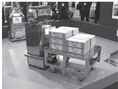
包装ライン導入予定の製品搬送ロボット ※同一ロボットで製品を搬送する。
