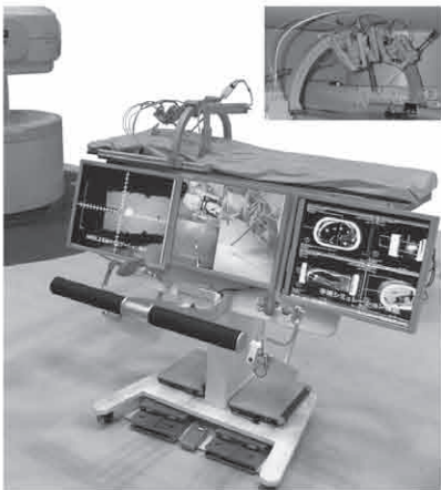
MR画像誘導下小型手術用ロボティックシステム (右上)MRIガントリ内に設置されたMR対応小型手術用マニピュレータ
