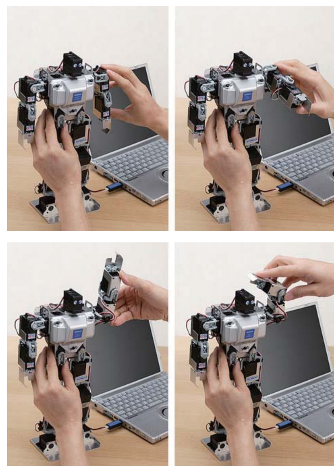
直接手で動かしてモーションデータをダイレクト入力
